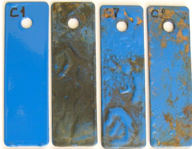
Рис. 6. Внешний вид образцов с системой покрытия: грунт СпецПротект 007 – эмаль СпецПротект 109 после проведения стендовых испытаний в газопаровой фазе при температуре t = 30\text{ }^{\circ}\text{C} (слева направо): контрольный, 360, 540 и 720 часов испытания
