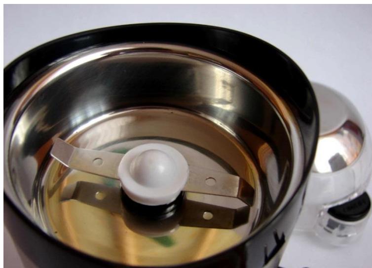
Рис. 5. Внутреннее строение камеры ножевой кофемолки
