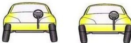
Рис. 1. Отрицательный и положительный развал автомобиля
