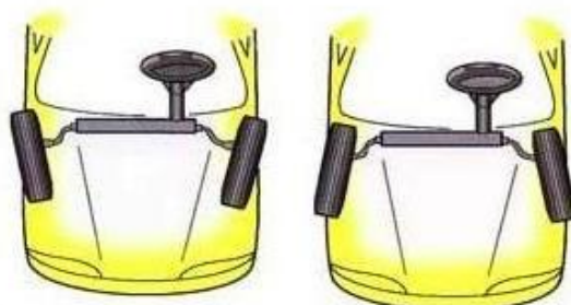
Рис. 2. Положительное и отрицательное схождение
