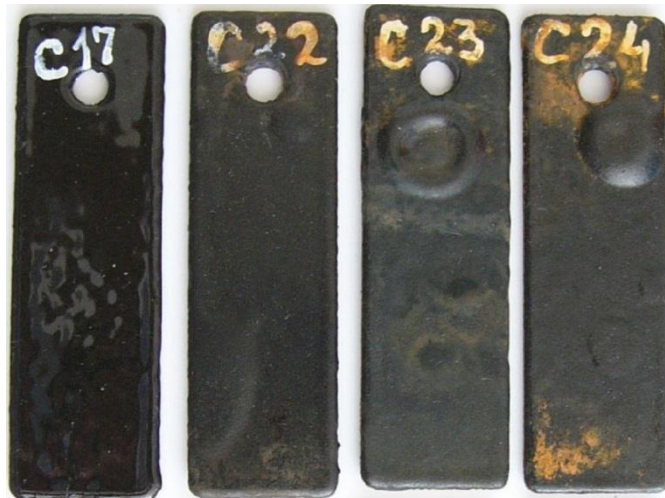
Рис.7. Внешний вид образцов с системой покрытия: грунт СпецПротект 006М – эмаль СпецИзолПремиум после испытаний в газопаровой фазе при температуре t=30\text{ }^{\circ}\text{C} (слева направо): контрольный, 360, 540 и 720 часов испытания
